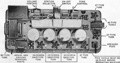
THESE CLIPS MUST BE CONNECTED TO SCREEN GRID TUBES BEFORE SET WILL OPERATE
